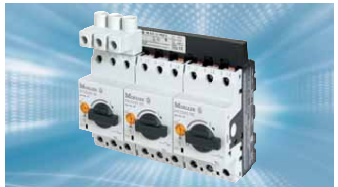
Bild 12: 3 Stück UL 508 Type E-Motorstarter (Type E Self-Protected Combination Motor Controller), hier dargestellt als kleine Gruppe mit Drehstromschienenblöcken, z. B. für die Applikation „Dezentrale Steuerung“. Entscheidend für Type E ist der große Einspeiseklemmblock BK25...-E, der hier einmal für mehrere Motorstarter gemeinsam genutzt wird. Er sorgt auf der Schaltereinspeiseseite für die großen Luft- und Kriechstrecken entsprechend UL 489. Dieser Klemmblock muss bei jedem einzelnen Motorstarter-Sammelschienenadapter, der nach Nordamerika exportiert wird, eingesetzt werden.
