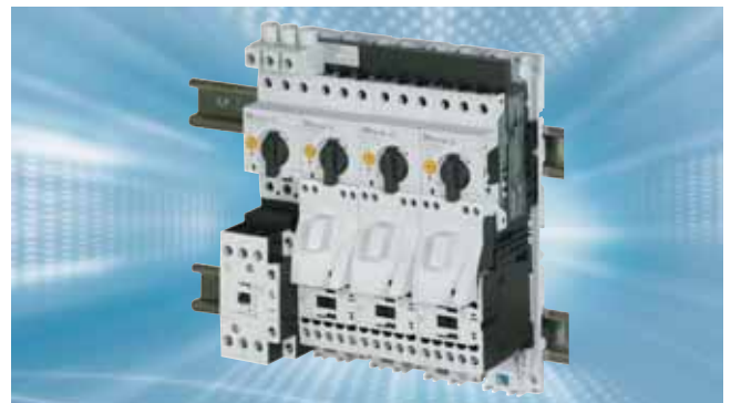
Bild 13: 4 Stück UL 508 Type F-Motorstarter (Type F Combination Motor Controller), hier dargestellt als kleine Gruppe mit Drehstromschienenblöcken und auf Tragschienen montiert, entstehen aus der Kombination von UL 508 Type E-Motorstartern mit gemeinsam geprüften Schützen. Type F-Motorstarter werden auch auf Sammelschienenadapter montiert, dann benötigt jeder Motorstarter für den Export nach Nordamerika wieder den Einspeiseklemmblock BK25...-E.
