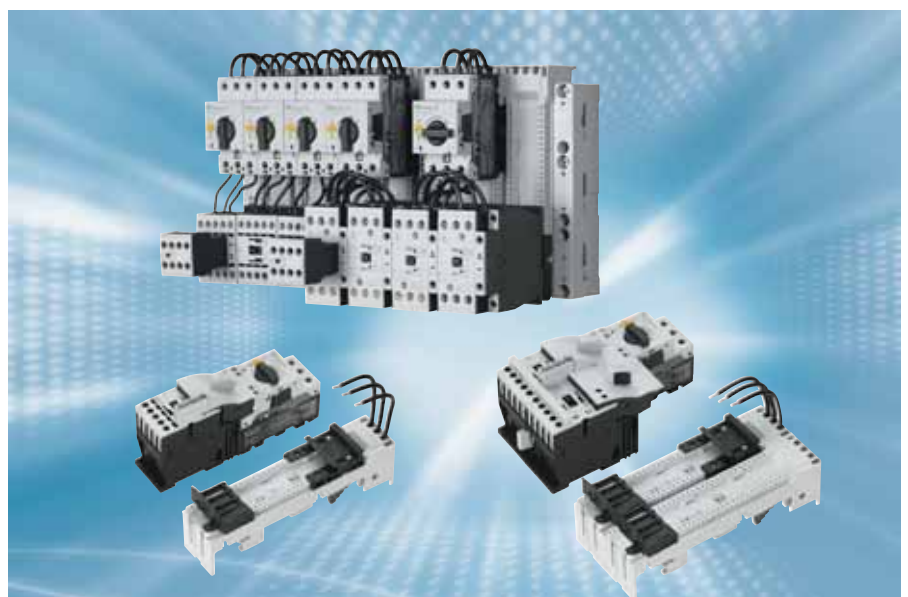
Bild 10: Die gemeinsam geschützte Gruppe von Motorstartern, nach Bild 9, benötigt keine großen Luft- und Kriechstrecken. Die Zusatzklemmen werden in diesem Fall nicht benötigt. In diesem Bild wird das erforderliche Gruppen-Vorschaltenschutzorgan nicht gezeigt.
