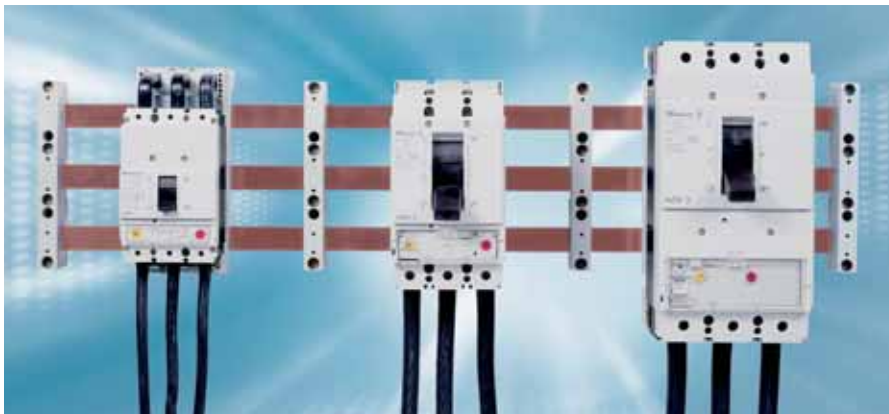
Bild 3: Mittlerweile ist es sogar möglich Leistungs- oder Lasttrennschalter mit Bemessungsströmen bis 550 A direkt auf die Sammelschienensysteme, als Einspeise- oder Abgangsschalter, zu adaptieren. Die Betätigungsmöglichkeiten für den Schalter sind sehr vielseitig, vom Handantrieb über den elektromotorischen Fernantrieb bis hin zum Bowdenzug für den typisch amerikanischen Side Handle. Für die Schalterbaugrößen NZM 2 und NZM 3 wurde eine Kurzschlussfestigkeit von 65 kA bei 480 V und 50 kA bei 600 V nachgewiesen. Beim Einsatz von NZM1 erreicht man 35 A bei 480 V.
