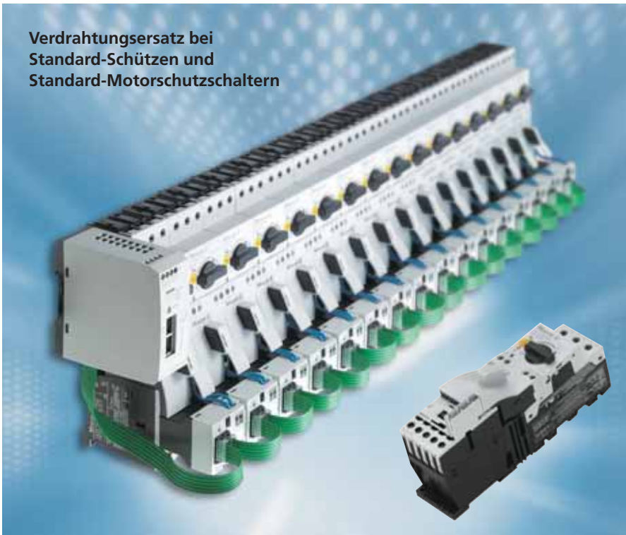
Bild 1: Das neue Vernetzungssystem easyConnect SmartWire von Moeller ersetzt in erster Linie die bisherige Steuerverdrahtung bei Motorstartern, indem es die Schützspulen ansteuert und die Rückmeldungen über den Schaltzustand vom Schützantrieb abgreift. Die Verbindung der einzelnen Bausteine, die auch auf Sammelschienenensystemen eingesetzt werden können, erfolgt durch konfektionierte Flachbandleitungen mit Steckern. Der Schaltzustand des Motorschutzschalters kann ebenfalls erfasst werden.
