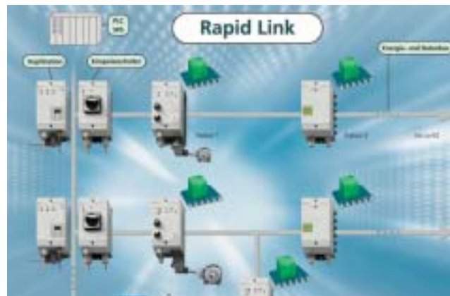
Bild 2: Topologie des Rapid Link Systems
