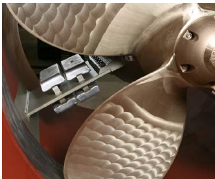
Bugstrahlruder BU90F, mit einem Rohrdurchmesser von 1600 mm und einer Antriebsleistung von 700 kW, erzeugt eine Schubkraft von 96 kN bei 1770 U/min.
