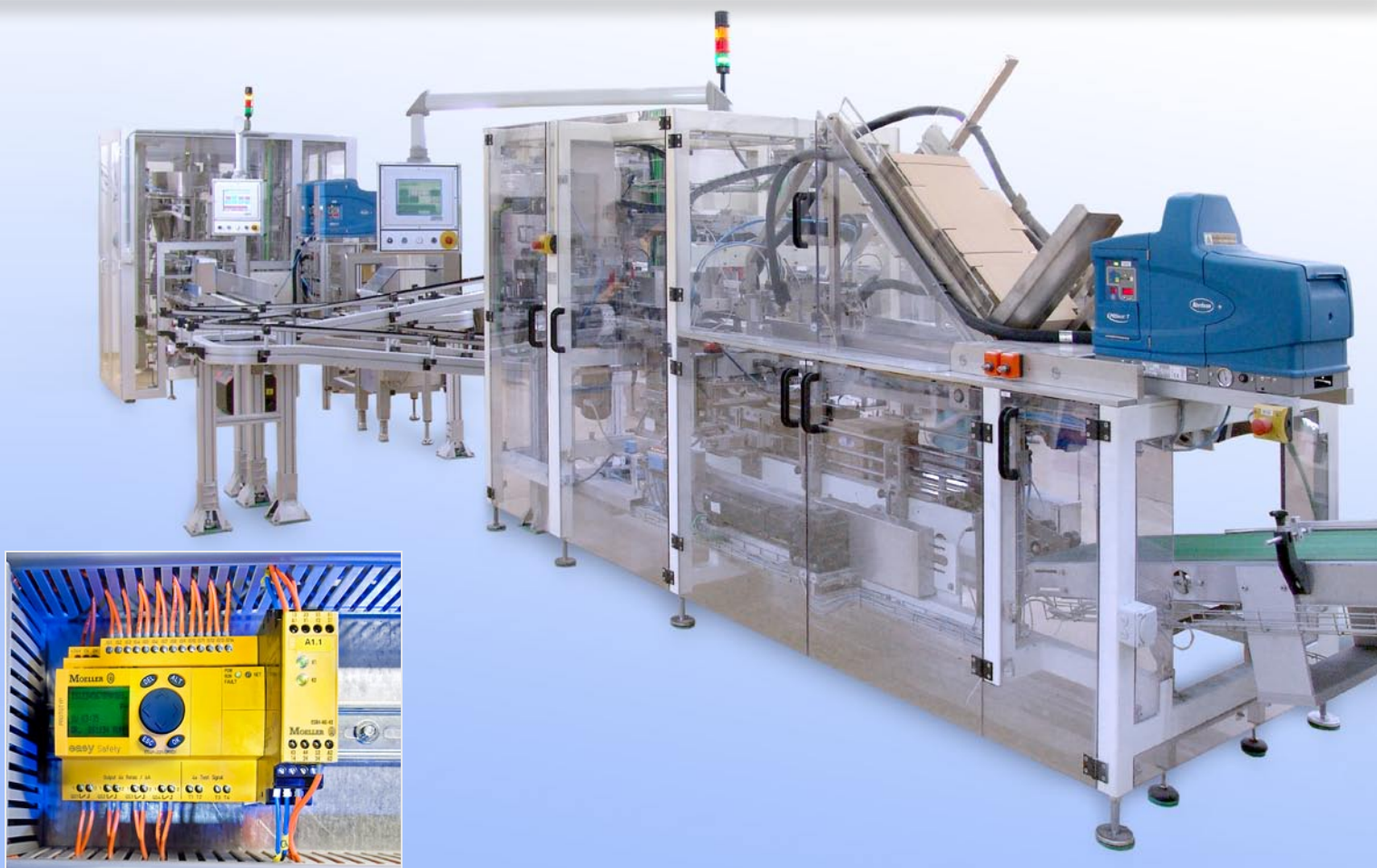
easySafety überwacht alle Tür- und Not-Halt-Kreise und kommuniziert über Profibus DP mit dem Motion-Control-System.
